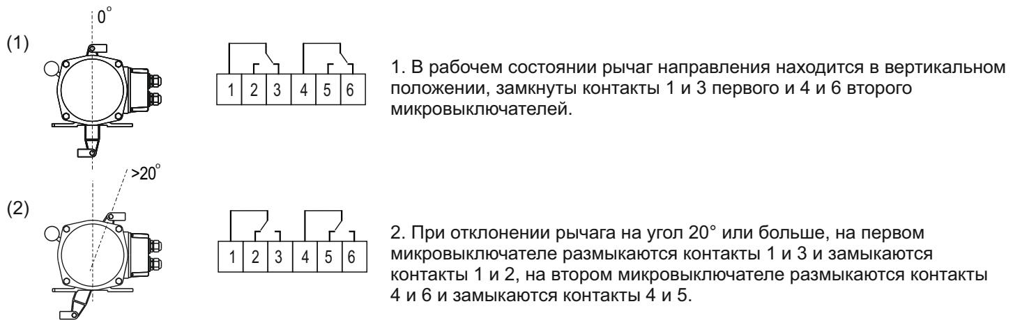
1. В рабочем состоянии рычаг направления находится в вертикальном положении, замкнуты контакты 1 и 3 первого и 4 и 6 второго микровыключателей.
