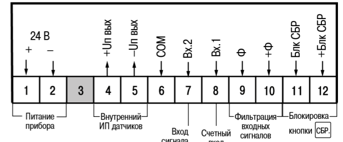
Рисунок 5.1 – Назначение контактов клеммника
