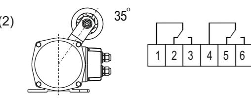
2. При отклонении ролика на угол 35° или больше, на первом микровыключателе размыкаются контакты 1 и 3 и замыкаются контакты 1 и 2. При этом на втором микровыключателе размыкаются контакты 4 и 6 и замыкаются контакты 4 и 5. Обратное переключение происходит когда угол наклона ролика становится меньше 35°.
