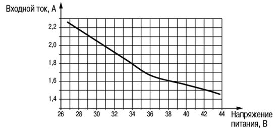
**Рисунок 3 – График зависимости входного тока (РСП ЖД-станций) от напряжения питания**
