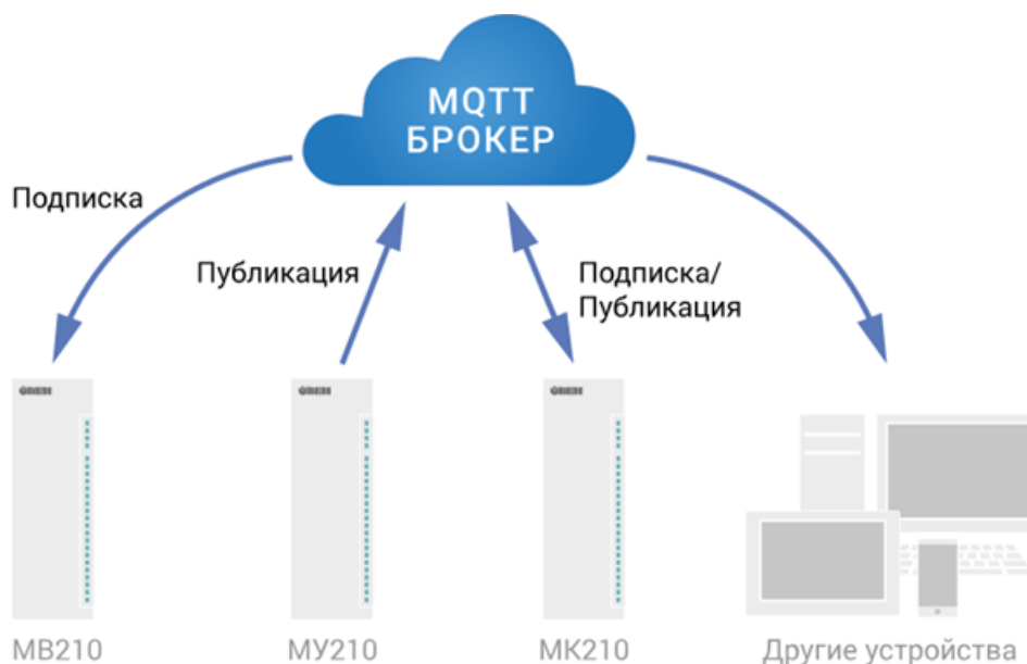
Рисунок 6.5 – Структурная схема обмена по протоколу MQTT
