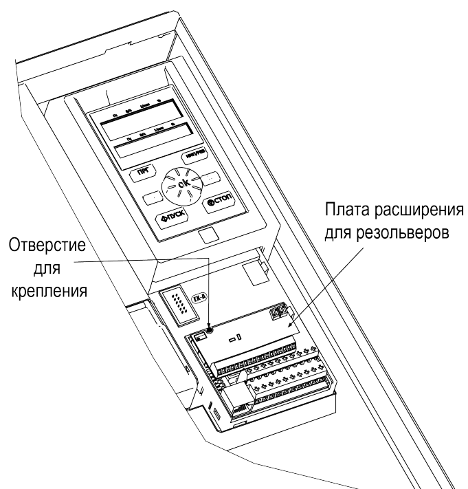
Рисунок 7.45 – Монтаж платы расширения для резольверов
