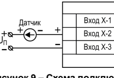
Рисунок 9 – Схема подключения пассивного датчика с токовым выходом 0...5 мА или 0(4)...20 мА
