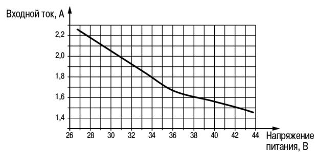
**Рисунок 6.2 – График зависимости входного тока (РСР ЖД-станций) от напряжения питания**
