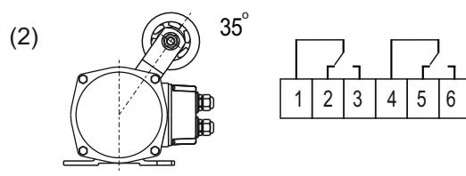
2. При отклонении ролика на угол 35° или больше, на первом микровыключателе размыкаются контакты 1 и 3 и замыкаются контакты 1 и 2. При этом на втором микровыключателе размыкаются контакты 4 и 6 и замыкаются контакты 4 и 5.
