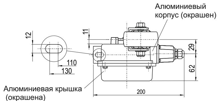
Взрывозащищенное и коррозионностойкое исполнения
