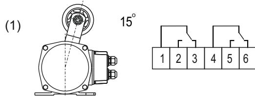
1. В свободном состоянии ось рычага находится под углом 15° к вертикальной оси датчика, замкнуты контакты 1 и 3 первого и 4 и 6 второго микровыключателей.
