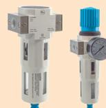
При первичном вводе в эксплуатацию пневмоцилиндров в блоках подготовки воздуха не требуется применение маслораспыления, поскольку в цилиндры на этапе сборки закладывается консистентная смазка. Однако после проведения ремонта или, если ранее маслосмазка осуществлялась, её прекращать нельзя. В маслораспылителях используйте только пневматическое масло.
