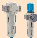
При первичном вводе в эксплуатацию пневмоцилиндров **KIPVALVE** в блоках подготовки воздуха не требуется применение маслораспыления, в цилиндры на этапе сборки закладывается консистентная смазка, но в случае его использования подачу масла прекращать нельзя. В маслораспылителях используйте только пневматическое масло.
