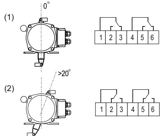
1. В рабочем состоянии рычаг направления находится в вертикальном положении, замкнуты контакты 1 и 3 первого и 4 и 6 второго микровыключателей.
